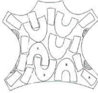
Şekil 2.4: İstampaların deri üzerine yerleştirilişi
