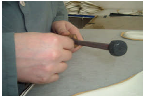
Resim 3.10: Masat ve kesim bıçağının tutuluşu
