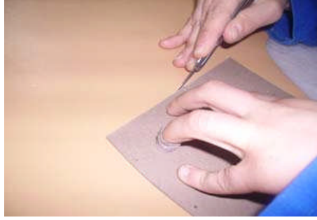
Resim 3.12: Kesim bıçağının tutuluş şekli
