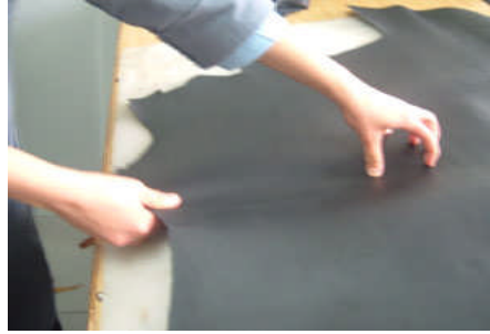
Resim 1.9: Deride sıklık yönü kontrolü
