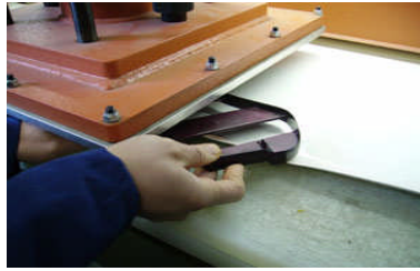
Resim 4.18: Kesim için bıçak ayarı
